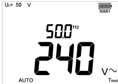
Figura 2, el instrumento muestra que el circuito tiene corriente.
