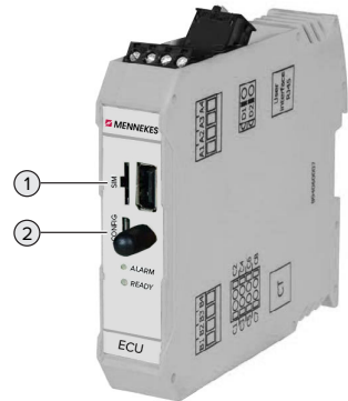
Abb. 15: Anschlüsse auf der ECU
