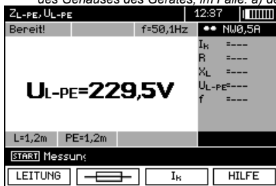
Überprüfung der Wirksamkeit des Stromschlagschutzes des Gehäuses des Gerätes, im Falle: a) des Netzes TN b) des Netzes TT
