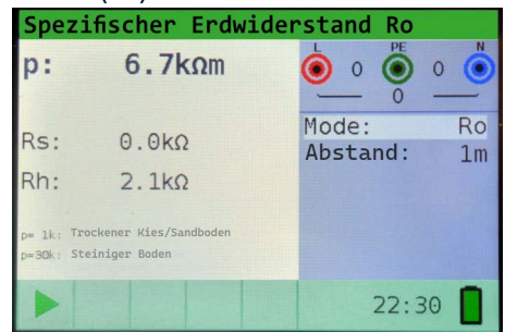
Abb. 9: Messung des spezifischen Erdwiderstands Ro, Kabelanschluss und Ergebnisse
