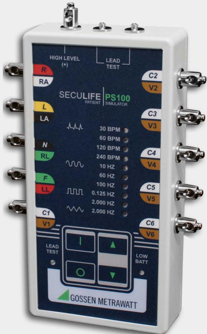
Der SECULIFE PS100 ist ein mikroprozessorbasierter Patientensimulator. Dem Anwender stehen vier EKG-Kennlinien mit konstanter QRS-Dauer, sowie sechs Kennlinien zur Prüfung der Geräteleistung zur Verfügung.
