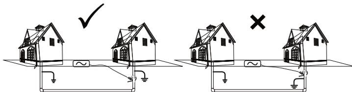
Die Signalzange hat den Vorteil, dass sie ein Signal an den Zielleiter anlegt und eine geringere Menge des Signals mit anderen gekreuzten Kabeln teilt. Wenn also die Kreuzkontaktierung nicht entfernt werden kann, hilft die Zange, die Energie auf ein bestimmtes Kabel zu konzentrieren, während andere Methoden die Energie gleichmäßiger verteilen.
