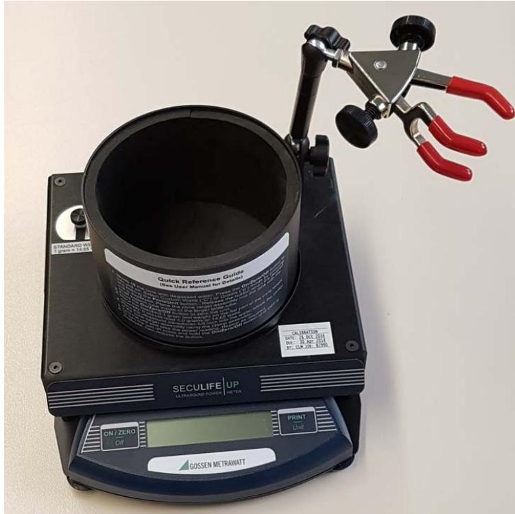
1. **On/Zero – Off** -Schalter: Um das Gerät anzuschalten oder auf Null zu setzen, drücken Sie den Schalter. Zum Ausschalten drücken und halten Sie den Schalter fest, bis OFF angezeigt wird.
