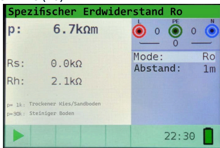
Abb. 22: Messung des spezifischen Erdwiderstands Ro, Kabelanschluss und Ergebnisse
