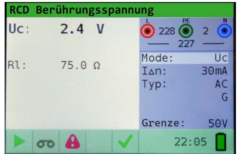
Abb. 10: Messung der Kontaktspannung, Kabelanschluss und Ergebnisse
