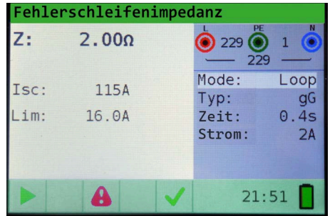
Abb. 14: Messung der Fehlerschleifenimpedanz, Kabelanschluss und Ergebnisse
