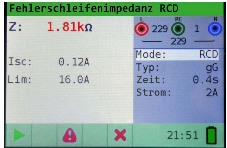
Abb. 15: Messung der Fehlerschleifenimpedanz mit FI, Kabelanschluss und Ergebnisse
