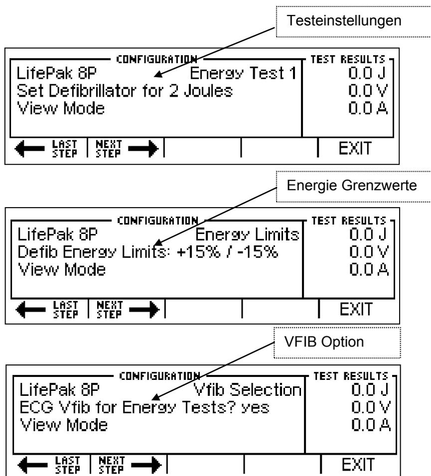
**MAXIMALE-ENERGIE-TESTS FÜR DEFIBRILLATOR:**
