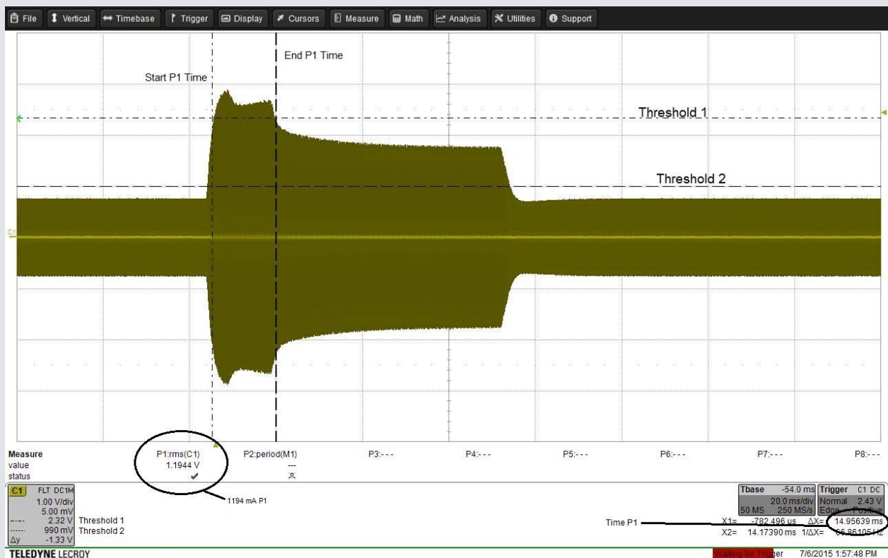
Angabe der Wellenform am SECULIFE ES PRIME , Oszilloskop Puls Daten
