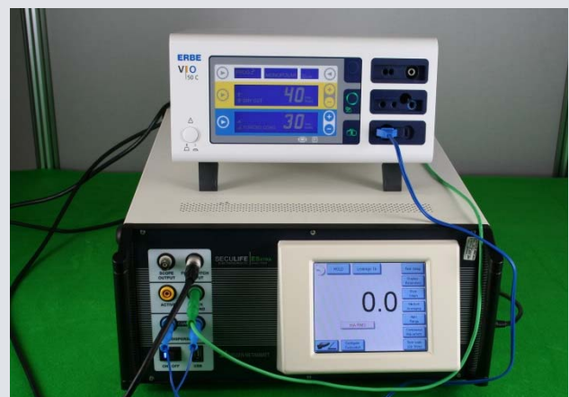
Abbildung: Neutralelektrode geerdet, Typ CF 1b z.B. Monopolar
