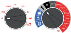
Um das Datum und die Uhrzeit einzustellen, wählen Sie die Einstellungsfunktion (Schlüssel) des mittigen Drehschalters. Drehen Sie dann den Modus-Drehschalter auf IR. Mit den Rechts-/Links-Pfeilen navigieren Sie zur angezeigten Uhrzeit und dem Datum.
