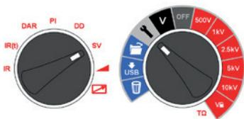
Bei einer regelmäßigen 5-stufigen SV-Prüfung werden die Widerstandsmesswerte für die ersten vier ‚Stufen‘ unter den aufeinanderfolgenden Zeitanzeigen ‚1m‘ bis ‚4m‘ angezeigt. Der 5-Minuten- Messwert wird am Haupt-Display angezeigt.
