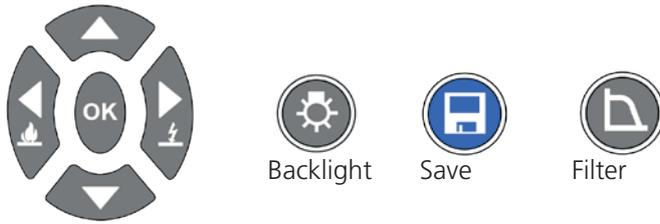
Vier Pfeiltasten und eine OK-Taste erleichtern die Anpassung und Auswahl von Einstellungen, Spannungspegel und Modi. Auswahl der Modi Durchschlag/Burn mit den Rechts/Links-Pfeiltasten. Dedizierte Tasten für die Hintergrundbeleuchtung, Speicherung und Filter.
