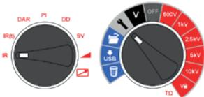
Für die Einstellung der benutzerdefinierten Lock-Spannung  $V_{\text{L}}$ , drehen Sie den mittigen Drehschalter auf die Einstellungen und den Modus-Schalter auf IR. Die voreingestellte Spannung blinkt und kann mit den Aufwärts/Abwärts-Pfeiltasten verändert werden. Wenn die erforderliche Höchstspannung angezeigt wird, drücken Sie die Taste OK, um die Einstellung zu speichern. Diese Einstellung bleibt erhalten, bis der Wert zurückgesetzt wird.
