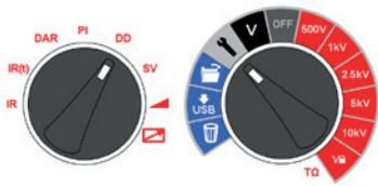
Die dielektrische Entlade- (DD) oder Resorptionsprüfung wird während der Entladung des geprüften Dielektrikums vorgenommen. Diese ursprünglich vom französischen Energieversorger EDF entwickelte Isolationsdiagnoseprüfung erlaubt die Überprüfung von Alterung, Verformung und Luft einschüssen in der zu prüfenden Isolierung. Das Ergebnis hängt von den Entladeeigenschaften ab, d. h., der innere Zustand der geprüften Isolierung hängt größtenteils nicht von der Verschmutzung der Oberflächen ab.
