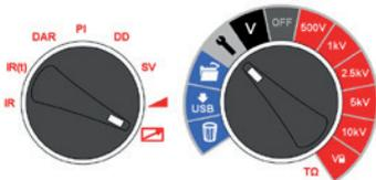
Die Bluetooth®-Schnittstelle wird eingestellt, wenn der Hauptdrehschalter auf Einstellungen zeigt, während der Modus-Schalter auf das Fernbedienungssymbol zeigt.
