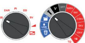
Eine zeitgesteuerte Prüfung IR(t) beendet automatisch die Isolationprüfung nach einer voreingestellten Periode. Standardmäßig ist der Timer auf 1 Minute eingestellt; dieser Wert kann mit der Einstellungsfunktion geändert werden. Dank dieser nützlichen Funktion muss der Anwender das Display nicht während der gesamten Prüfdauer beobachten und die 1-Minuten-Messintervalle werden akkurat erfasst.
