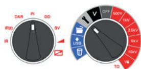
DAR- und PI-Prüfungen sind Messungen des Widerstands im Zeitablauf, die als ein Verhältnis des Widerstands zum Zeitpunkt t2 durch den Widerstand zum Zeitpunkt t1 ausgedrückt werden. Es wird davon ausgegangen, dass die Isolationstemperatur während der Prüfdauer nicht stark variieren wird, sodass der DAR- und/oder PI-Wert unabhängig von der Temperatur sind. Damit diese Annahme zutreffend ist, müssen die Prüfungen bei Temperaturen von max. 40 °C (104 °F) durchgeführt werden.
